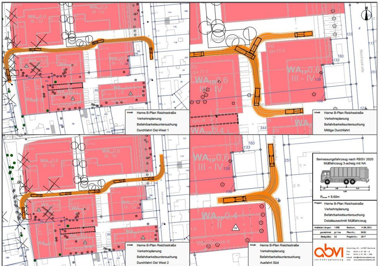
Abbildung 3 Befahrbarkeitsuntersuchung für ein Müllfahrzeug 3-achsig mit NA, 12,00 m Länge
